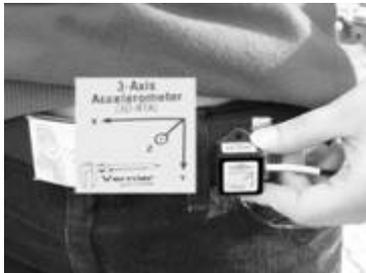
Als Sensor wurde ein 3D-Sensor verwendet, der Beschleunigungen in allen 3 Raumrichtungen misst. Bei der Auswertung wurde daraus rechnerisch auch die Gesamtbeschleunigung (Vektorsumme) ermittelt und im Diagramm dargestellt.
