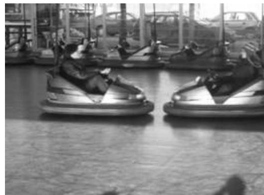
Da sich mit Coach mehrere Objekte analysieren lassen, wurden bei der Videoauswertung in jedem Bild 4 Punkte markiert. So konnten die Weg/Zeit-Diagramme der beiden Wagen und der beiden Personen gewonnen werden.
