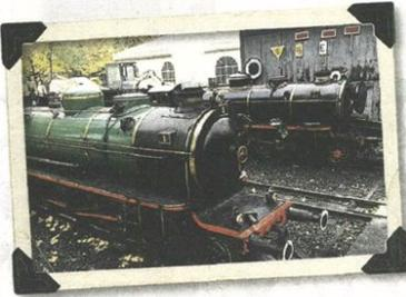
Die Geschichte der Parkeisenbahn durch den Wiener Prater fing bereits im Jahr **1928** an. Da sind zum ersten Mal die beiden **2-Zylinder-Nassdampflokomotiven** mit Steinkohlebefuerung Da1 und Da2 in Betrieb gegangen.
