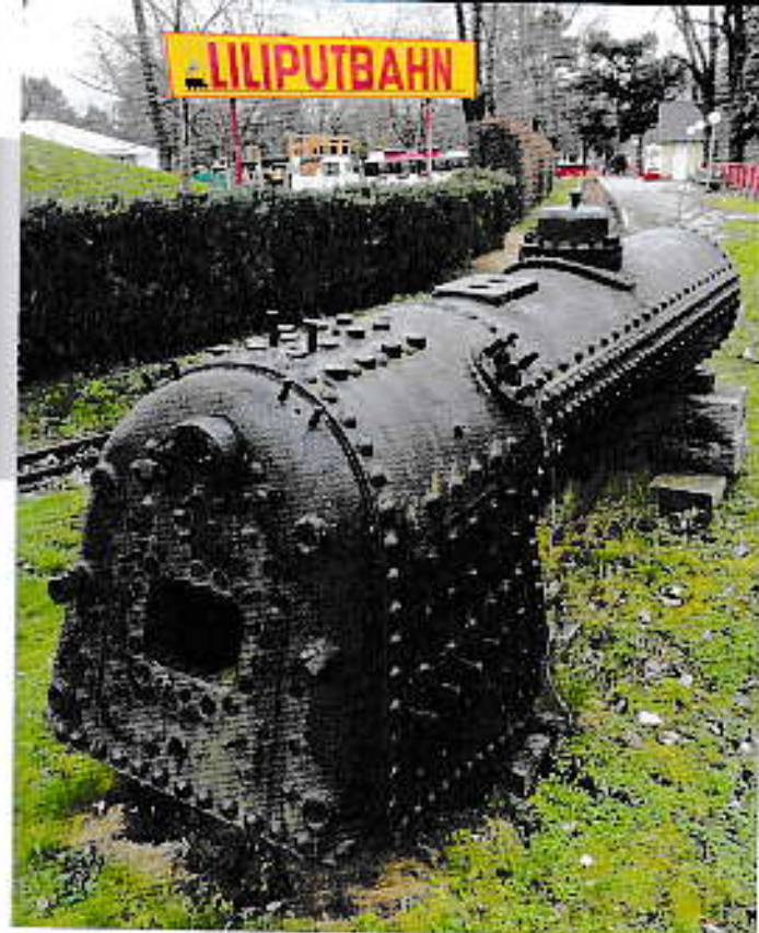
Der alte genietete Dampfkessel der Dampflok Nr. 1 steht heute als Erinnerungstück beim Liliputbahn-Hauptbahnhof. Sie leiten den Betrieb: Inhaberin Anna Kleindienst und Geschäftsführer Alexander Rühner (Photo: © Liliputbahn)
